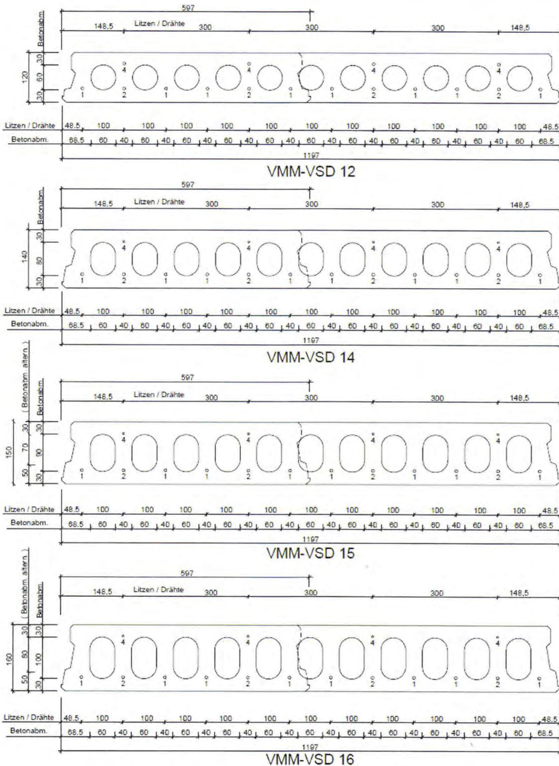
Verwendung von Spannbeton-Hohlplatten
