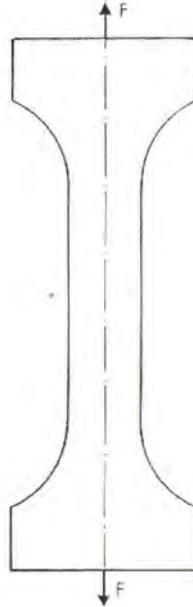
**Bild 2:** Belastungsanordnung Zugversuch
