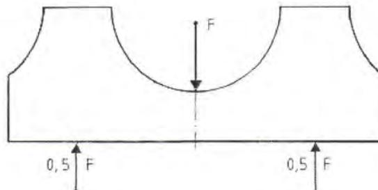
**Bild 1:** Belastungsanordnung Biegeversuch
